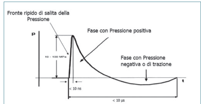
Figura 1. Curva pressione/tempo di un'onda d'urto. (www.SITOD.it). Dal valore di riferimento della PA (1 Atm = 101,325 Pascal) il gradiente dell'onda raggiunge rapidamente (rise time 5-10 ns) i valori massimi della pressione al picco P + (10-100 Mpa). Segue il lento decremento (2000 nsec) della pressione sino ai valori sub-atmosferici della fase di tensione (10-20% di P Max). Il punto di caduta logaritmica del 50% della pressione massima a-6 dB, esprime la distribuzione media dei valori di pressione positiva nell'isobara ellissoide del volume focale.
